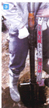
落下高さ確認
