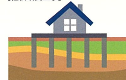
【柱状改良工事】
